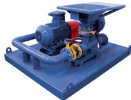
射流混浆装置
